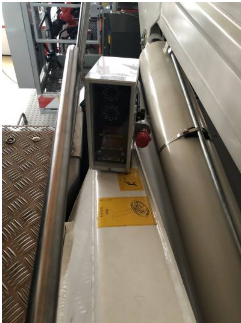
Atemluftanschluss, Druckanzeige und Restdruckwarner am Hauptsteuerstand
