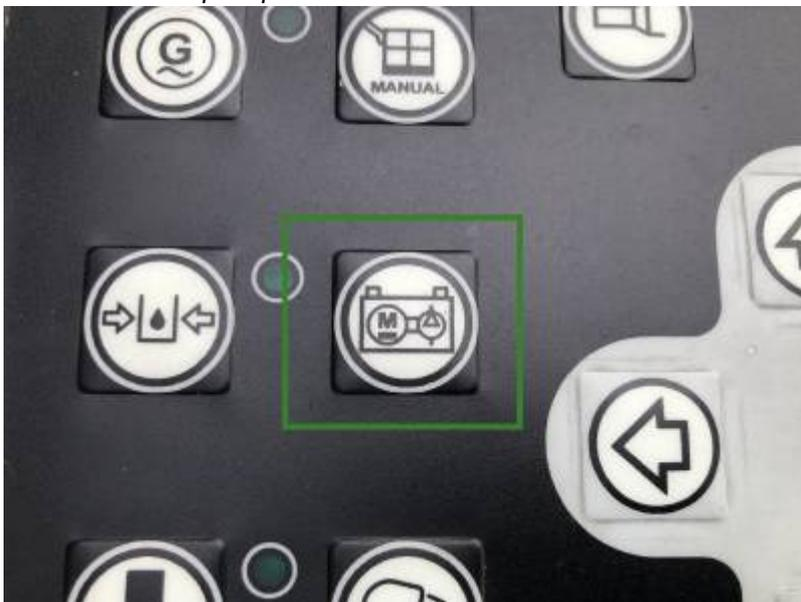
Der Taster muss zum Verfahren gedrückt gehalten werden. Der Teleskopmast lässt sich in weiterer Folge wie gewohnt bedienen. Die Fahrgeschwindigkeit ist jedoch eingeschränkt. Damit die Batteriepumpe nicht überhitzt, darf diese **maximal 5 Minuten durchgehend aktiv** sein. Danach muss eine 5-minütige Pause eingelegt werden. Nach den 5 Minuten Pause, darf die Pumpe wieder 5 Minuten aktiv sein.
