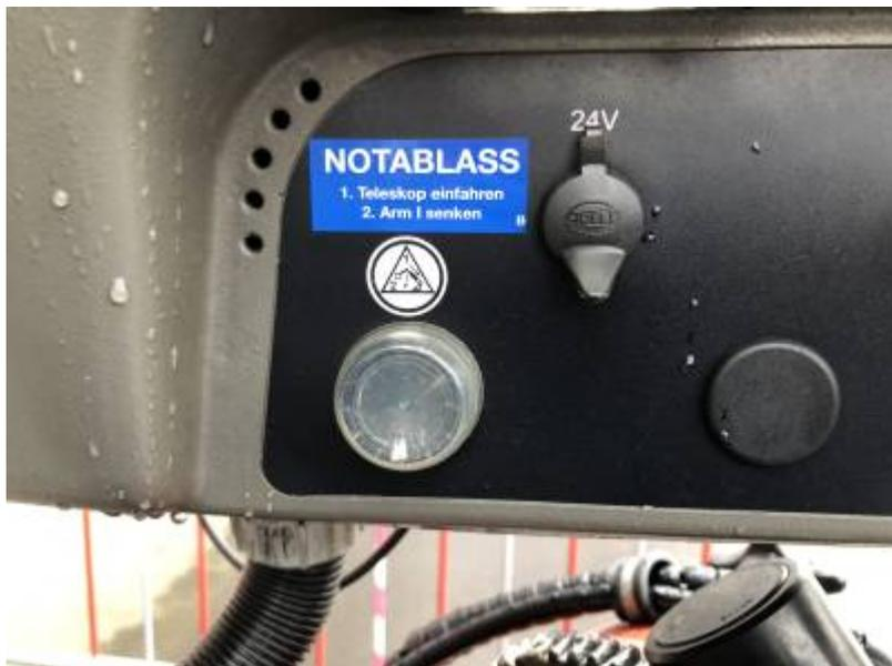
*Taster für Notablass am Hauptsteuerstand*
