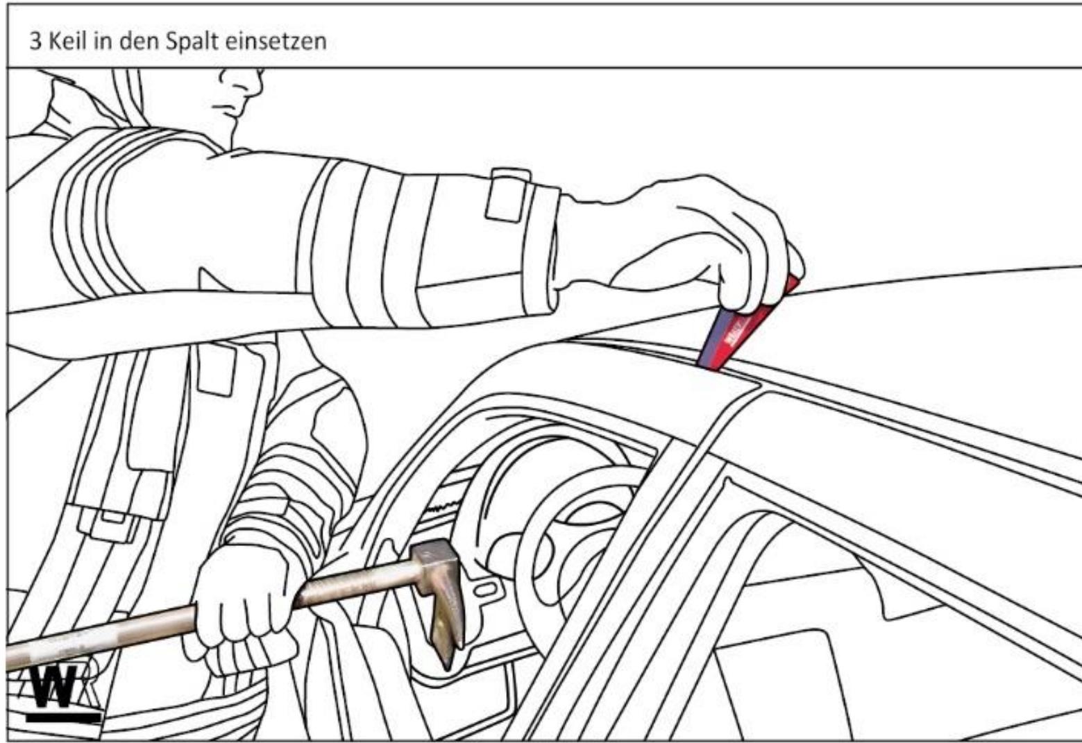
4 Spalt vergrößern, Keil rutscht nach und hält den Spalt für das Ansetzen des Spreizers offen
