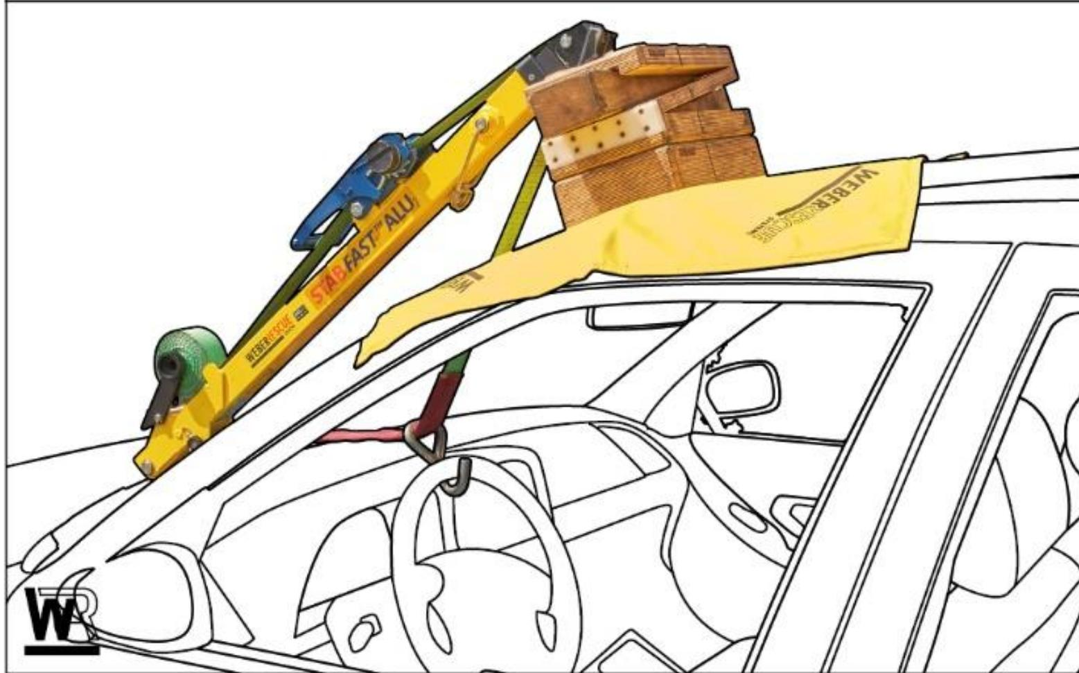
4 STAB-FAST betätigen, Lenkrad wird nach oben gezogen
