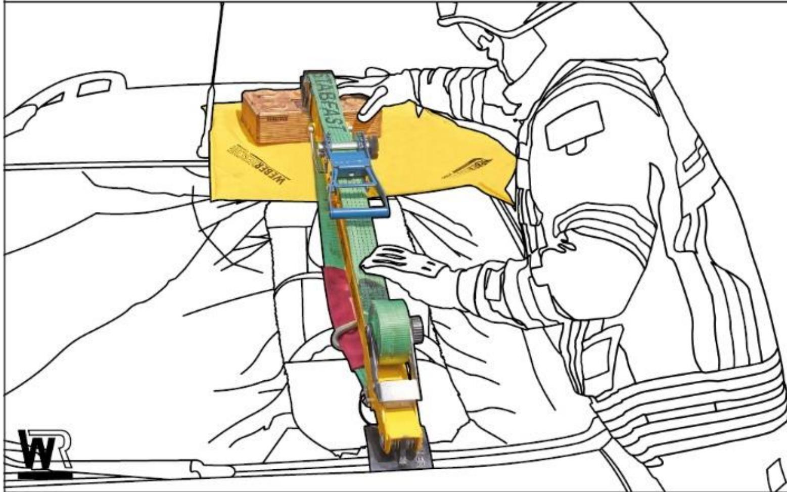
3 Mit Haken an Lenkrad oder mit kurzer Bandschlinge um Lenksäule befestigen
