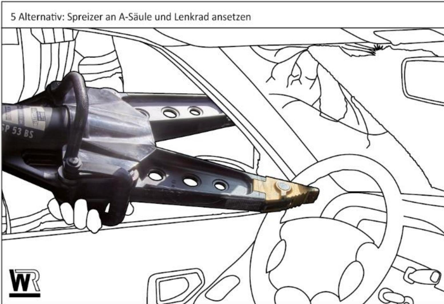
6 Spreizer schließen und Lenkrad zur Seite ziehen
