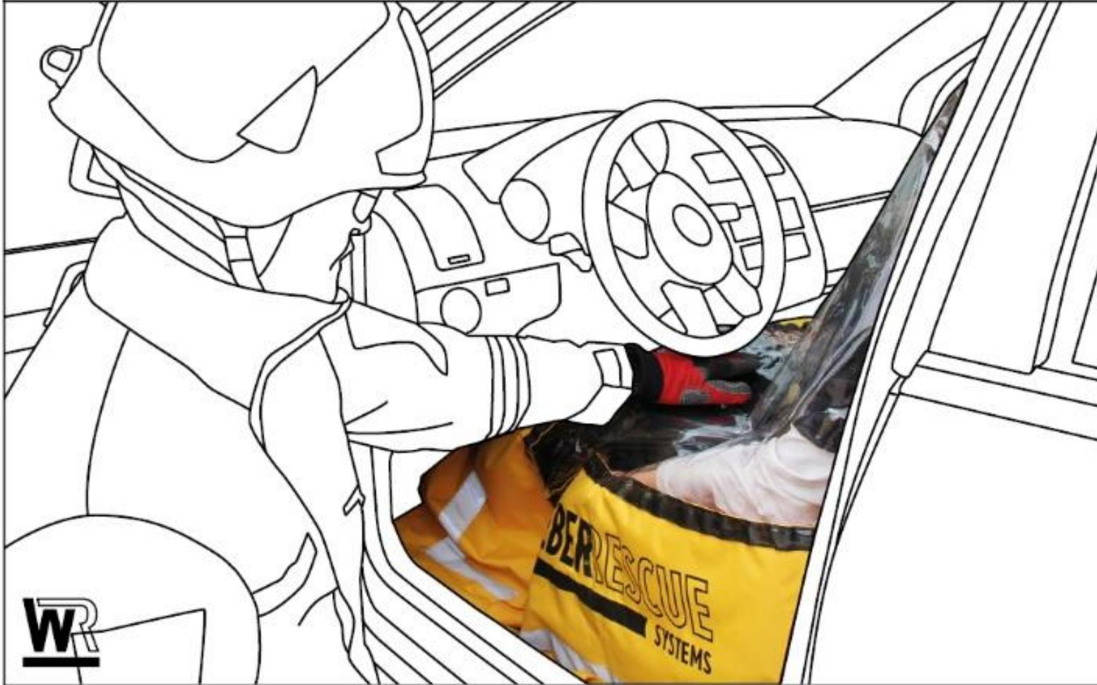
2 Spanngurt unter Lenkrad durch Innenraum führen
