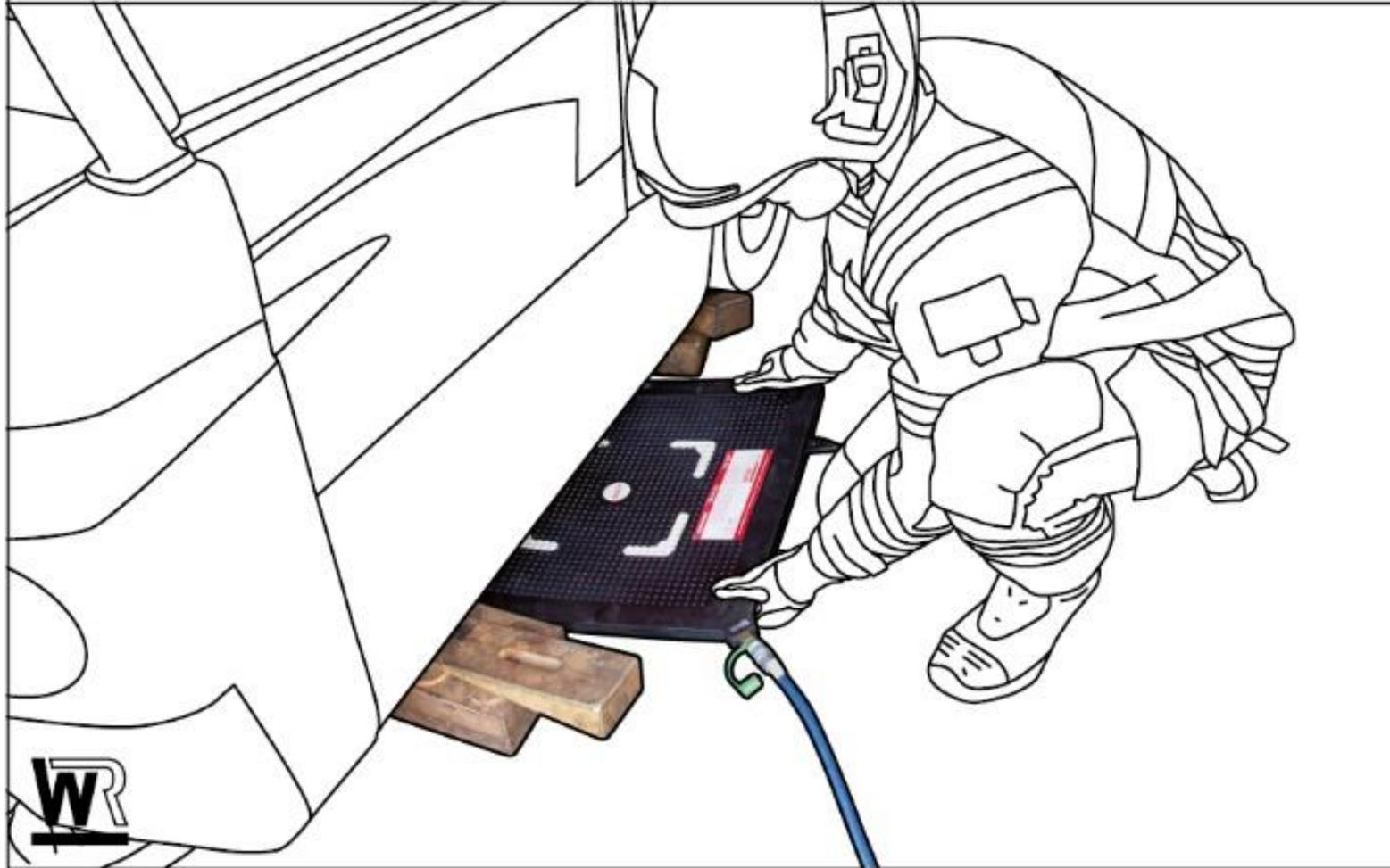
5 Hebekissen gleichzeitig aufblasen und Stapler anheben
