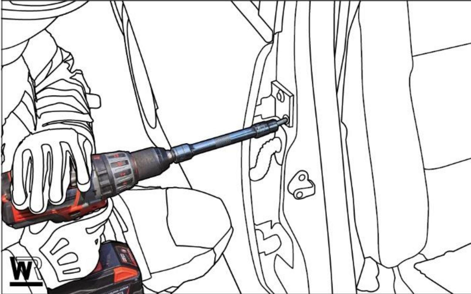
3 Mit Spreizer Zugang zu restlichen Schrauben erweitern
