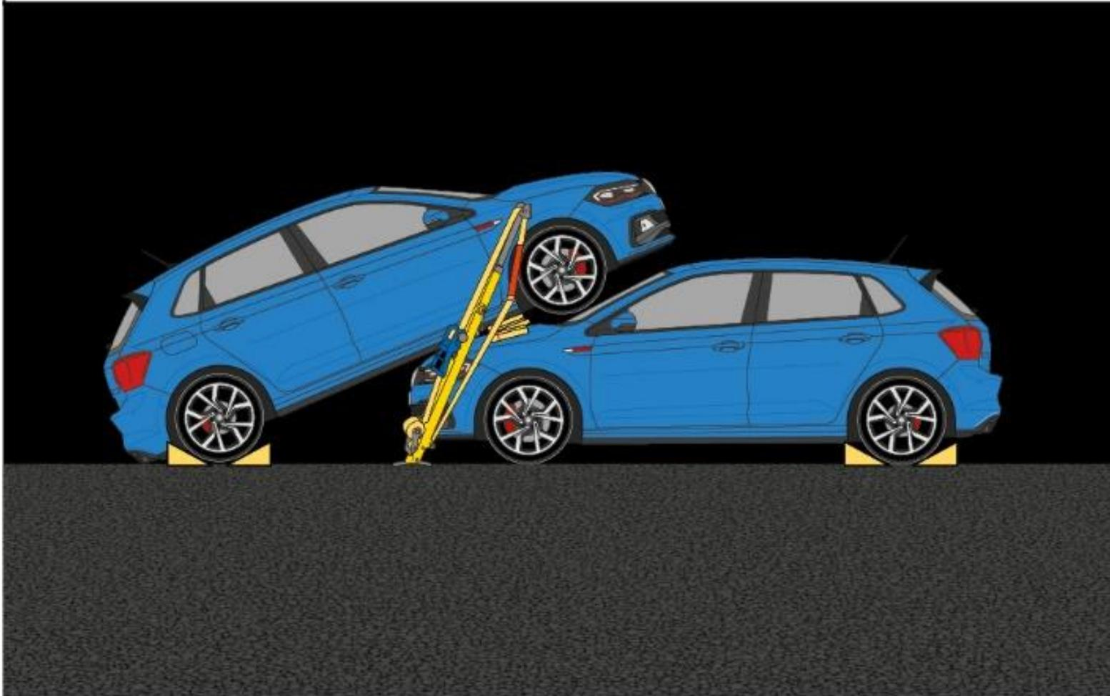
4 Sicherung mit STAB-FAST an beiden Fahrzeugseiten
