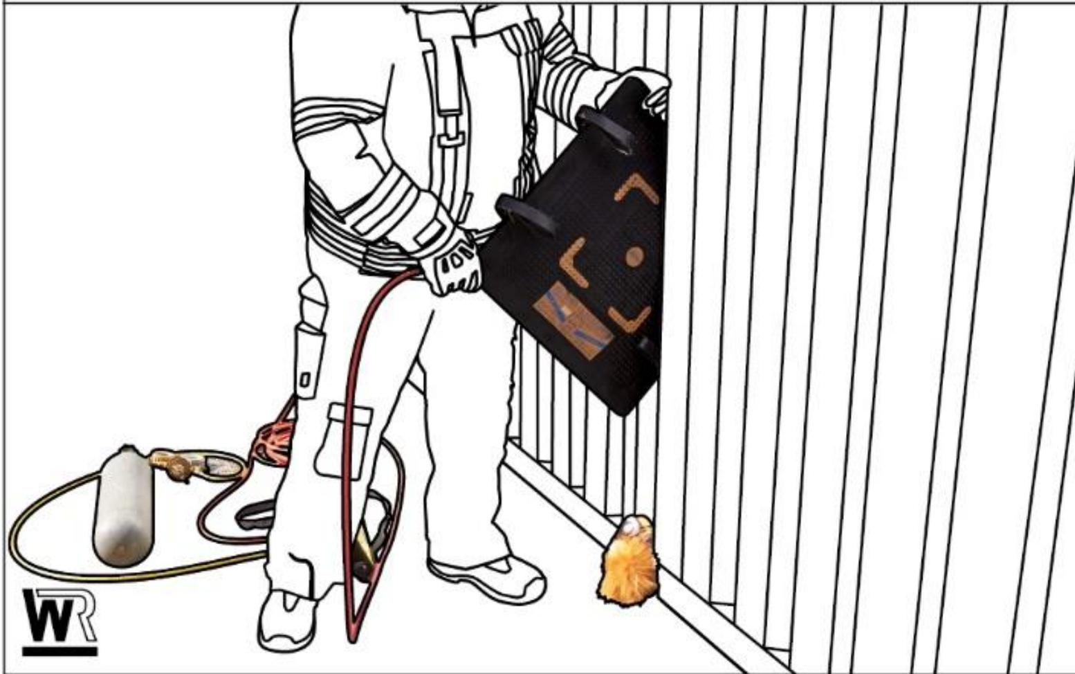
4 Hebekissen befüllen, um Spalt zu vergrößern
