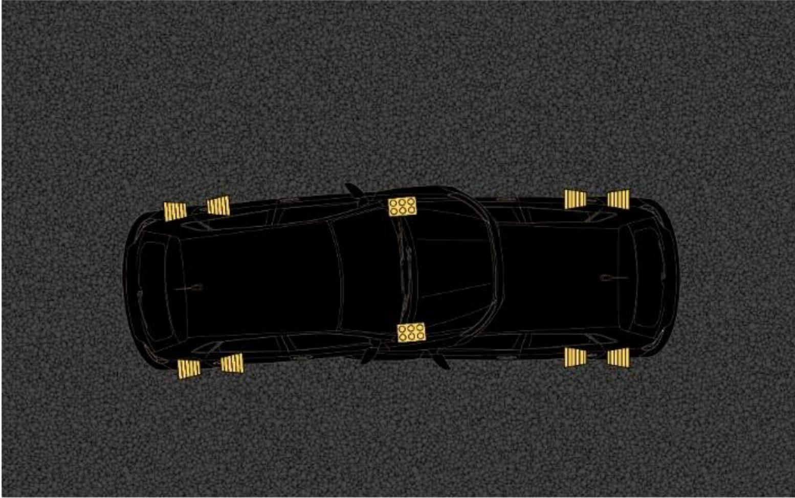
3 Oberes Fahrzeug seitlich gegen Kippen mit STAB-FAST stabilisieren
