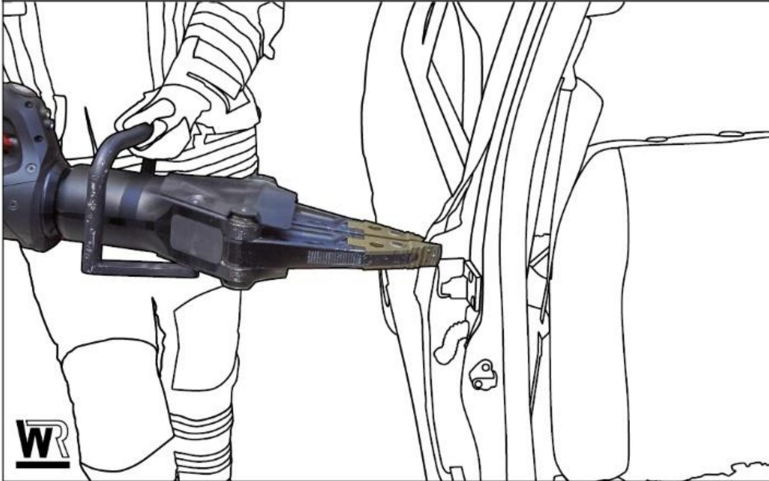
4 Restliche Schrauben entfernen und Tür herausheben
