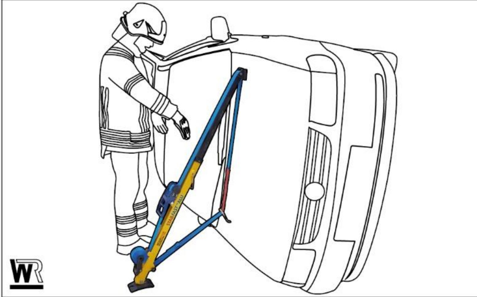
4 Equipment: STAB-FAST und Stufenbohrer
