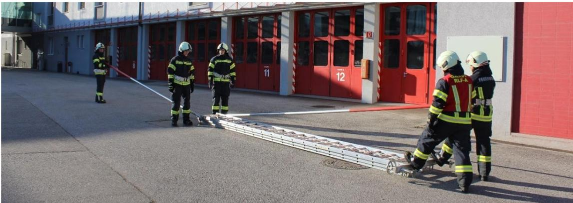
Ausgangsposition für das Aufstellen parallel zur Gebäudefront mit einer überhobenen Stützstange.
