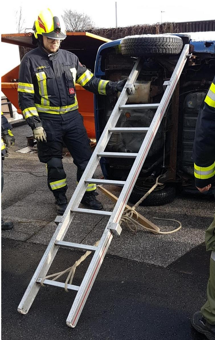
Sichern eines PKW's. Alternativ kann auch ein Zurrgurt verwendet werden.
